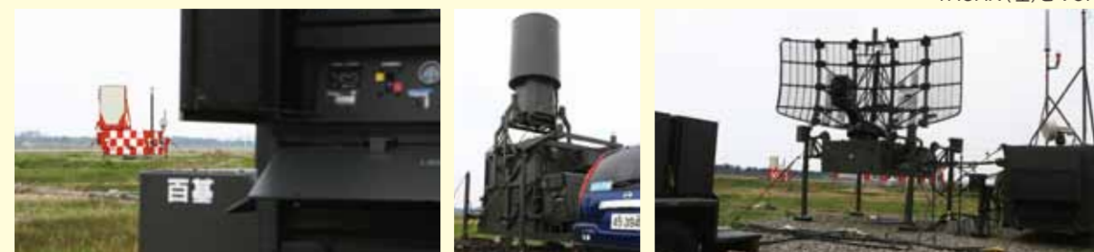
2011年5月、東日本大震災被災のため松島基地で運用中の施設。左から、移動式ラコン装置 PAR 装置・タカン装置(移動用)・移動式ラコン装置 ASR 装置
