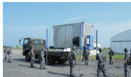
人命救助システム車両積載(油圧式ジャッキ装置での積載)
