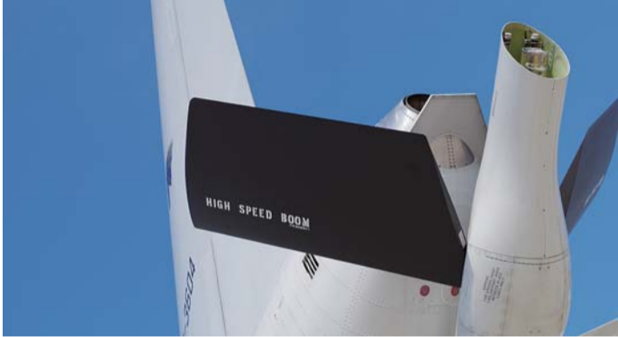
① フライング・ブーム 黒い羽のようなものがラダーペーター。その下のブームからテレスコップ・チューブが伸び給油した (今回は6 m)
