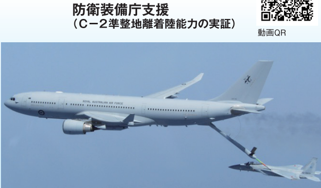
F-15技術的追認(豪空軍KC-30Aとの空中給油適合性確認試験)
