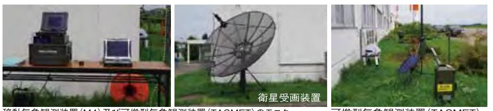
移動気象観測装置(M4) 及び可搬型気象観測装置(TACMET)のモニター
